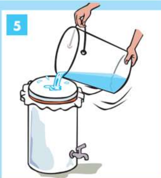
เทน้ำที่ผ่านการบำบัดลงในภาชนะ โดยผ่านการกรองด้วยผ้าสะอาด
